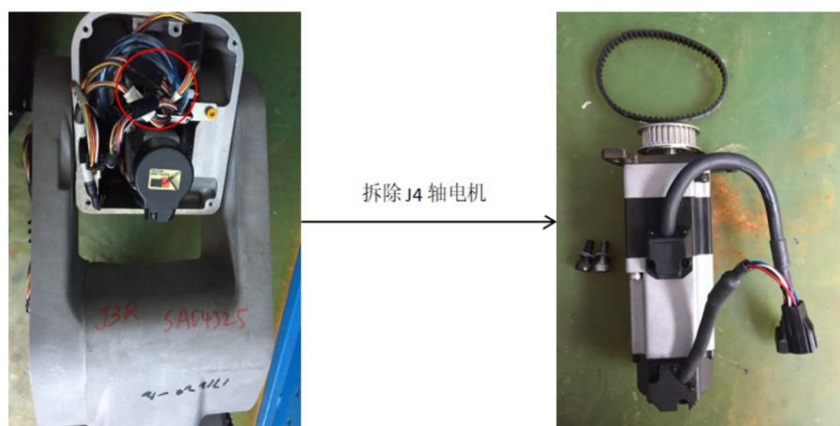
图 8 拆卸 J4 轴电机示意图
