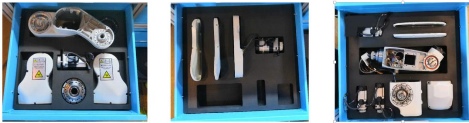
图 5、6、7 工业机器人 2—6 轴的拆卸与装配
