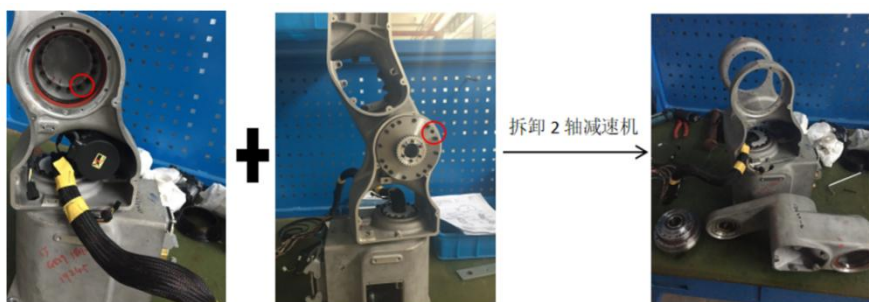
图 10 J2 轴减速机拆卸示意图
